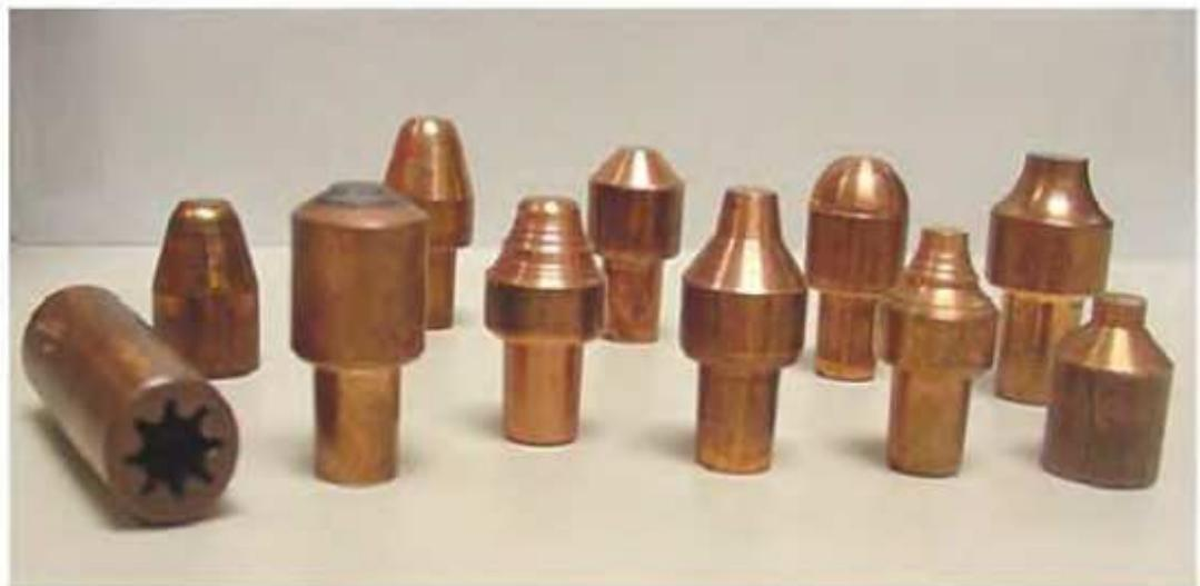
Vrhovi elektroda sa povećanom čvrstoćom se biraju kada se zavaruju materijali sa povišenom čvrstoćom.
